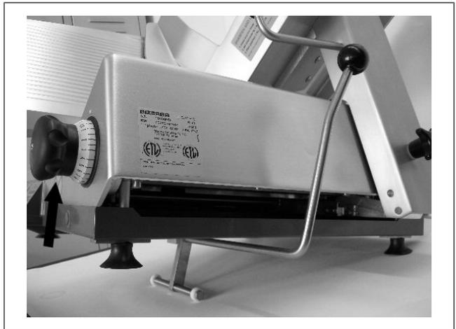
Fig. 31: Lifting device GSP HD
